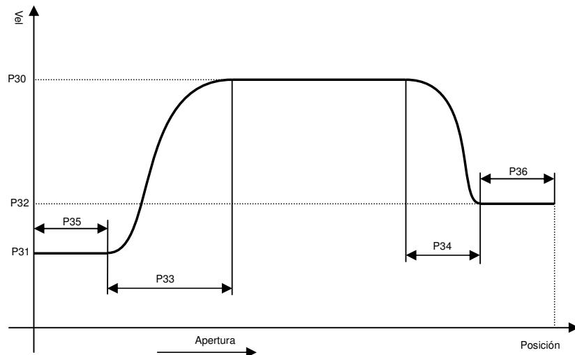
Perfil del generador VF Cerrando y Abriendo con Encoder ( no fuerza en tope )
