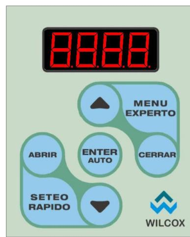
Teclas ↑ y ↓: Permiten la navegación entre los diferentes parámetros ó variables mostradas en el indicador luminoso y cuando se está modificando el valor de un parámetro permiten aumentar o disminuir su valor. Es posible cambiar la orientación de los
