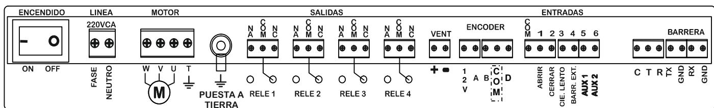
En la nueva caja SEQUAX se hicieron algunas modificaciones en la zona de alimentación, puesta a tierra y encoder. El borne de alimentación es de dos vías, allí van conectados Fase y Neutro.
